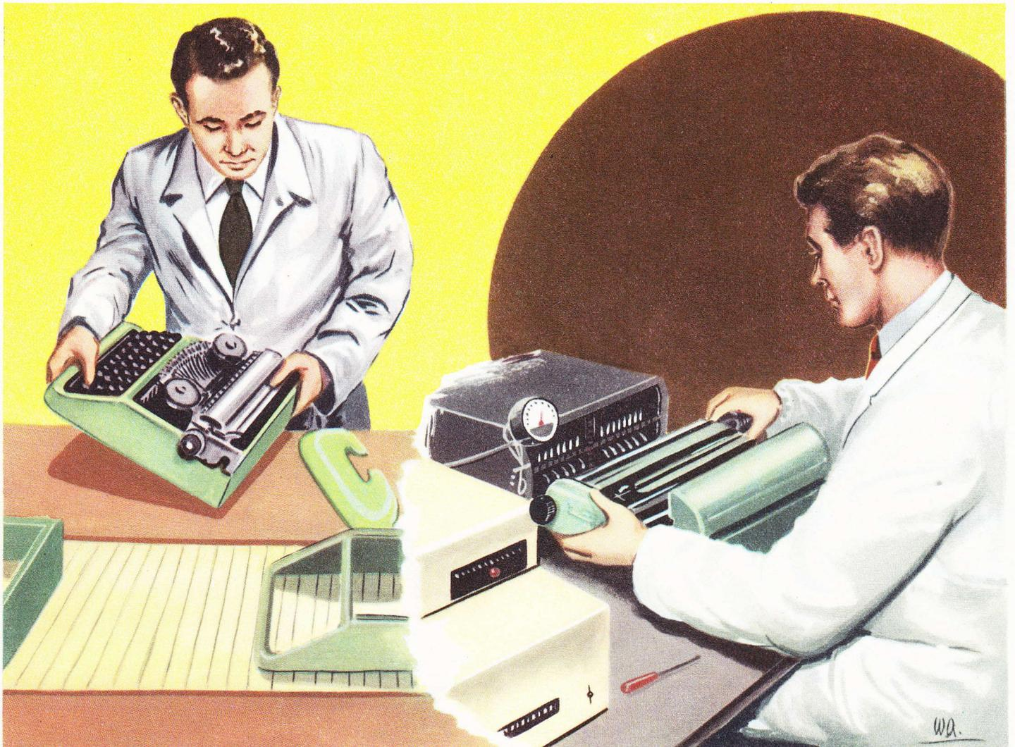
*Dans les grandes usines où l'on fabrique les machines à écrire, on a adopté les méthodes de production les plus modernes. La phase finale du montage en chaîne (à gauche): les différentes pièces, déjà préparées, se déplaçant sur des bandes transporteuses, sont montées dans une suite d'opérations par une main-d'oeuvre spécialisée, ce qui permet une économie de temps et garantit un fonctionnement parfait. Avant d'être mises en vente les machines sont soumises à des essais.*
